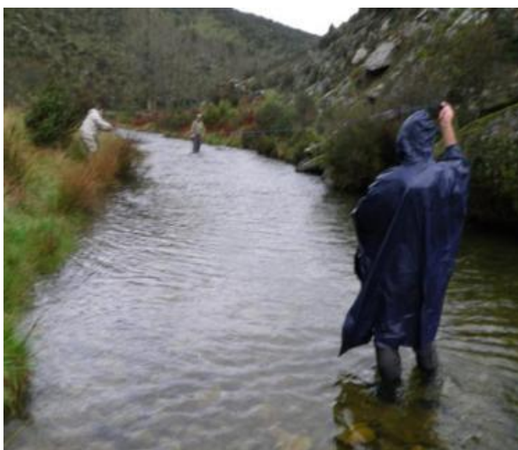
Medición del caudal mediante el sistema del flotador. Abril 2010
